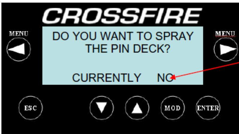
Fonctionnement de la pompe de dégraissant sur le "pin deck"
