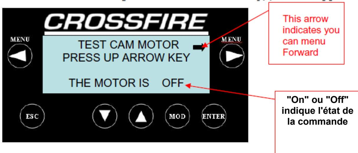
**Le menu ci dessus permet de tester le moteur de commande des cames (sortie 01).**
