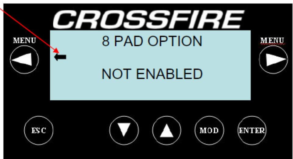
Cet écran indique que la machine est **équipée de 6 pads** e que l'option 8 pads n'est pas installée.
