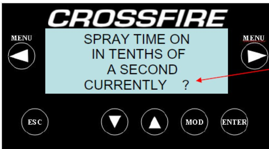
Temps de fonctionnement de la pompe de dégraissant
