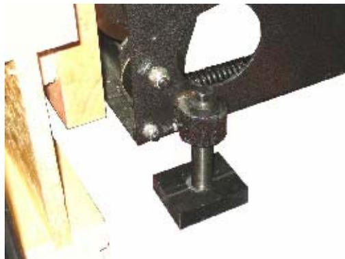
**Fig. 4-8 Mise à niveau de la Face Arrière**
