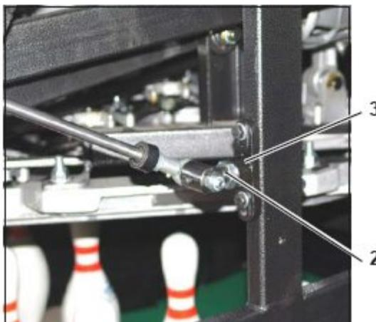
Le premier réglage de hauteur de la barre de Râteau doit être fait en première position de garde (66°). Le Râteau doit être arrêté dans cette position et ensuite le moteur de Râteau doit être tourné manuellement d'un cran afin que la barre de Râteau bouge un petit peu vers l'arrière du pindeck.
