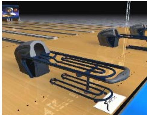
**Figure 2-10 Mécanisme de Retour de Boule**
