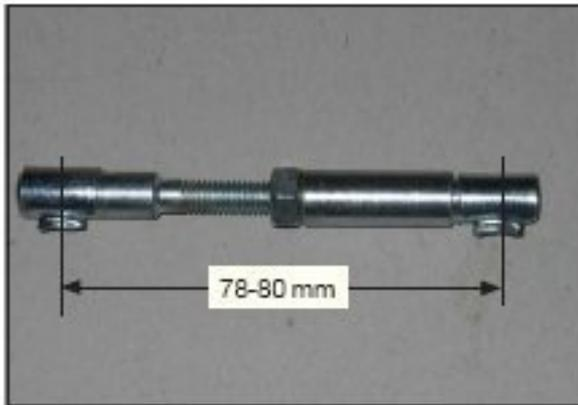
Fig. 8-18 Ajustement des raccords principaux d'entraînement.
