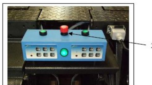
Fig.5-5 interrupteur d'arrêt d'urgence
