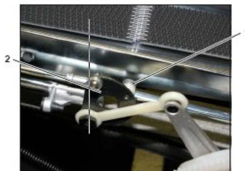
Fig. 8-41 Culbuteur de débrayage
