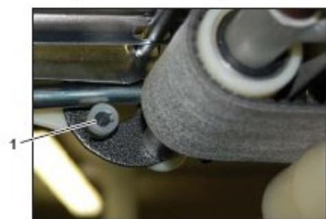
Fig. 8-43 Ajustement de bielle de débrayage
