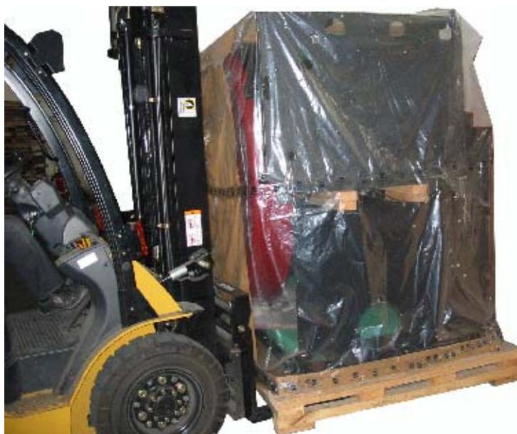
**Fig. 3-7 Manutention de la machine – Faces Arrières**
