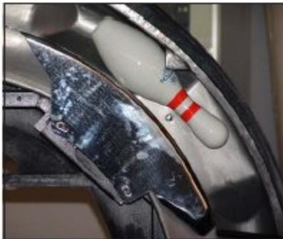
Le point de départ du réglage en hauteur est déterminé en plaçant une quille dans une poche de la roue à quilles et en arrêtant la roue lorsque la quille est proche du centre du rail de guide de quille. Montez ou descendez le rail jusqu'à ce que la quille soit tenue en place mais sans trop de pression provenant des supports anti-vibrations du rail.
