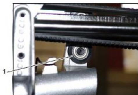
Fig. 8-42 Roulements déportés
