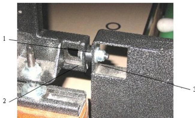
L'entretoise 1 (Fig. 4-6) de 10 mm fournie avec le kit matériel doit être placée entre les deux cadres pour assurer un espacement suffisant aux opérations du Distributeur.
