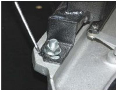
Fig. 8-11 Ajustements en fonction des kickbacks.
