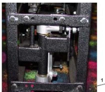
Fig. 8-50 Ajustement de l'unité de capteur de boule
