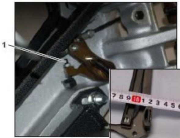
Fig. 8-19 Boulon de butée
