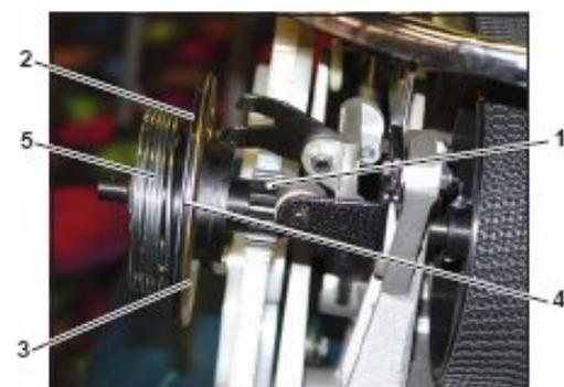
Fig. 8-44 Mécanisme d'embrayage
