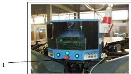
Fig.5-4 interrupteur d'arrêt d'urgence
