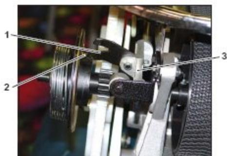
Fig. 8-38 Disque d'embrayage et lame de butée
