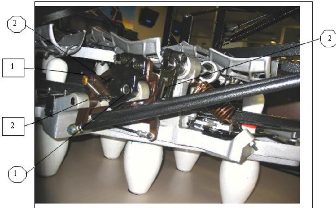
**Fig. 7-8 Mécanisme de biellette de boîte de vitesse de la Table**
